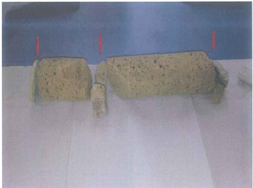
Carotaggi eseguiti: muratura in blocchi di tufo
